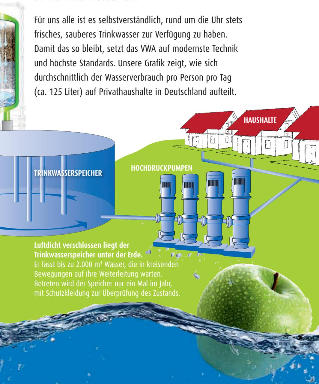
**Luftdicht verschlossen liegt der Trinkwasserspeicher unter der Erde.**
